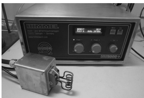
Abbildung 11. Induktives System für das maschinengestützte Erhitzen der Säule eines kontinuierlichen Durchflussreaktors. Übernommen aus Lit. [54a].
