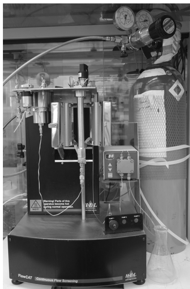
Abbildung 8. Der HEL-FlowCAT-Rieselreaktor wurde zur Hydrierung von Nicotinsäureethylester über einem Festbettkatalysator verwendet.
